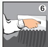
Нанесите клей зубчатым шпателем. Уложите плитку в течение 15 минут после нанесения клея на основание. Выровняйте плитку в течение 10 минут.
